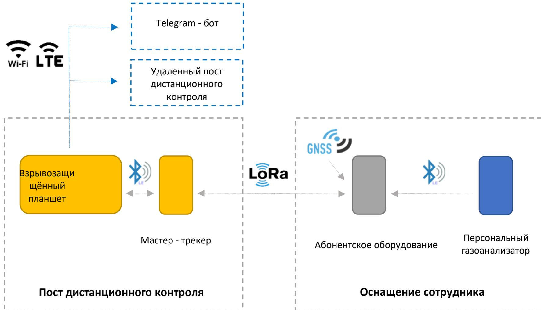
Рис. 3.2 Организация работы ПАК с дополнительными функциями
