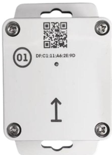
Каждый радиомаяк имеет цифру на корпусе (рис. 4.9). Цифра соответствует номеру, запрограммированному в маяке. Радиомаяк вещает в эфир этот номер в режиме advertising.
